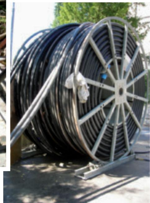
Haspel mit GEROtherm® Erdwärmesonden DE 50mm
