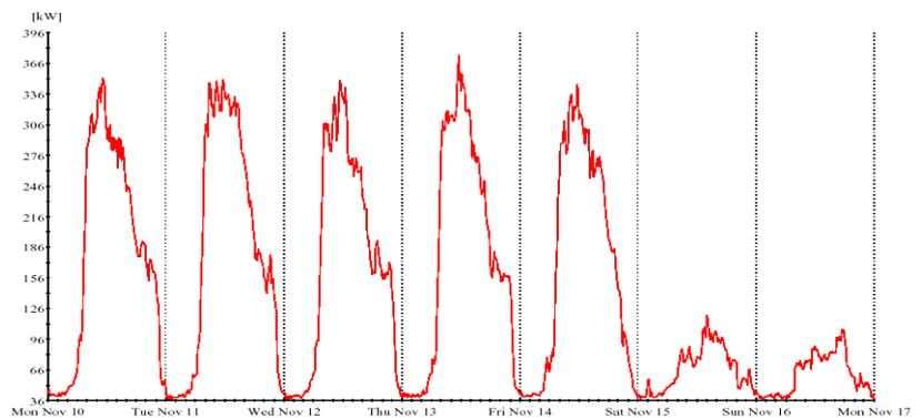
Mit je 1/3 des Stromverbrauchs schlugen die Beleuchtung und die Lüftung zu Buche. Hier wurde bei der Betriebsoptimierung angesetzt und insbesondere beim Licht konnte mit Bewegungsmeldern beträchtlich gespart werden.
